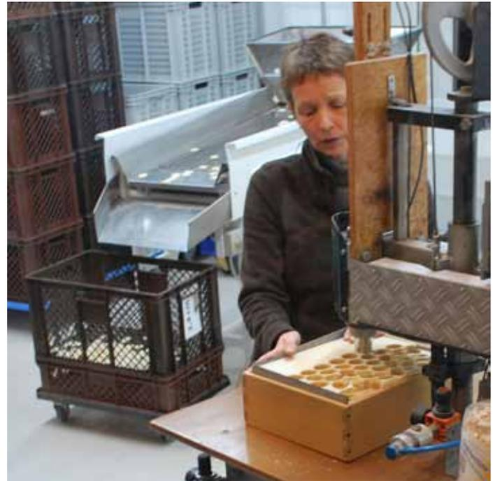
Hostie entspricht, in hunderte kreisrunde Hostien geschnitten werden. Dann laufen die Hostien über einen Sortiertisch, um Krümel und zerbrochene Hostien auszusieben und werden zum Trocknen in einen Trockenraum mit 30 % Luftfeuchtigkeit gebracht. Am Schluss werden die Hostien abgewogen, verpackt und an die Kirchen verschickt.
